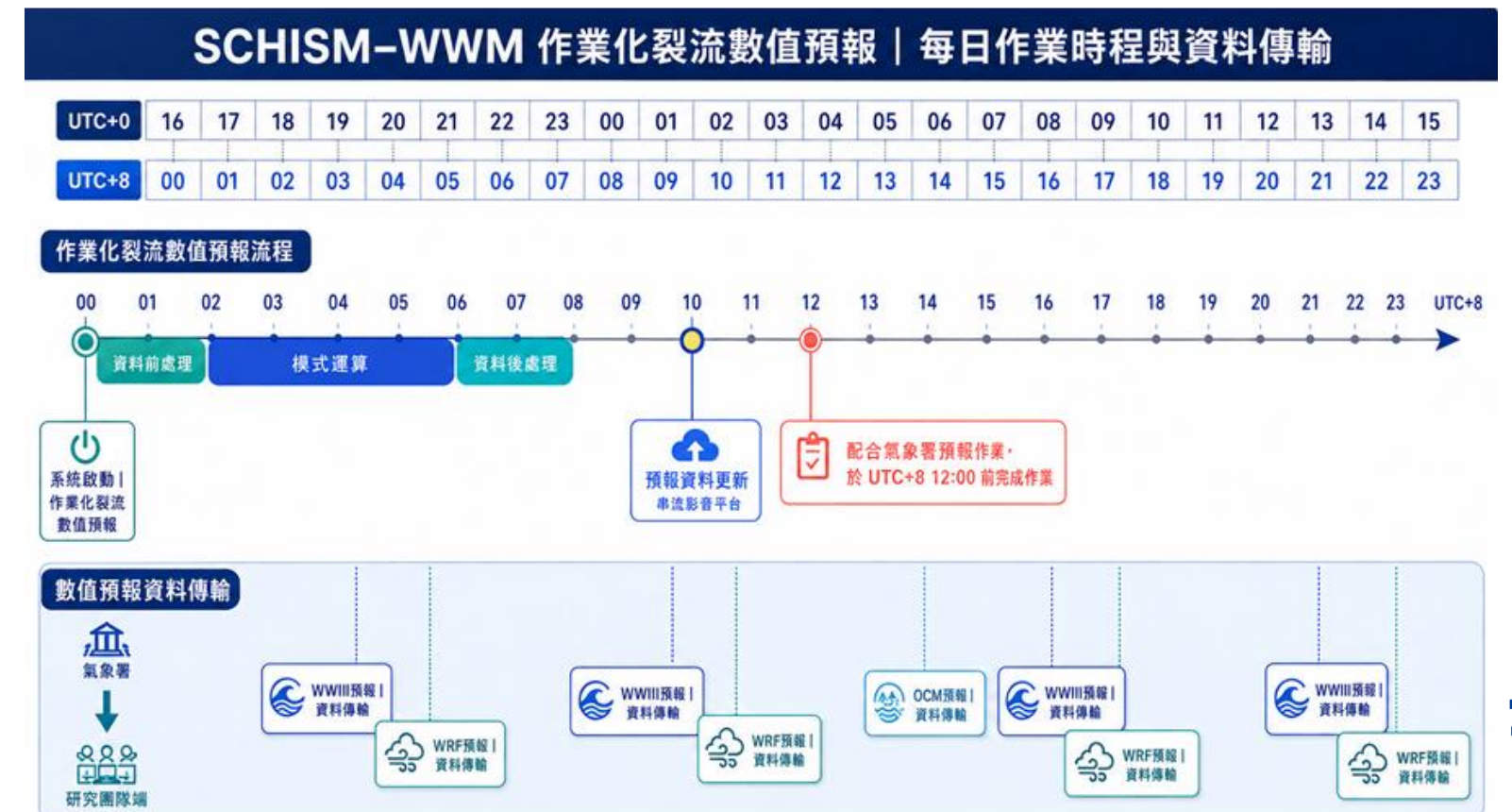
SCHISM-WWM 作業化裂流數值預報系統流程圖
