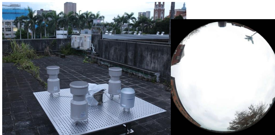
本實驗室頂樓降雨比對試驗場(定期校正)
