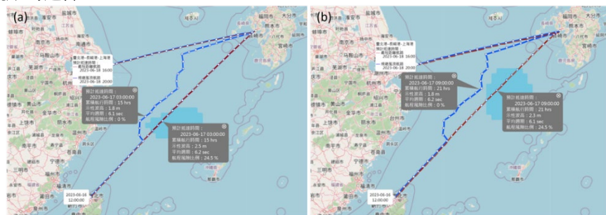
圖 1 規避風浪航路 (藍線) 與大圈航路 (紅線) 2條航路規劃結果
