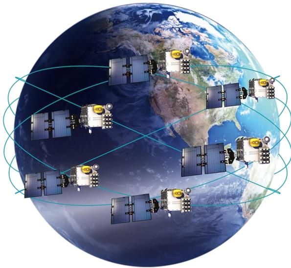
圖 1：福爾摩沙衛星七號共有6顆衛星分佈於軌道傾角約24度、高度520至550公里的軌道上運行。
