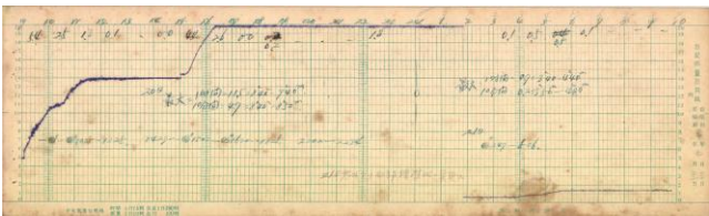
圖17 1945年9月20日臺南站虹吸雨量儀自記紙上紀錄「21日西部標準時更改」
