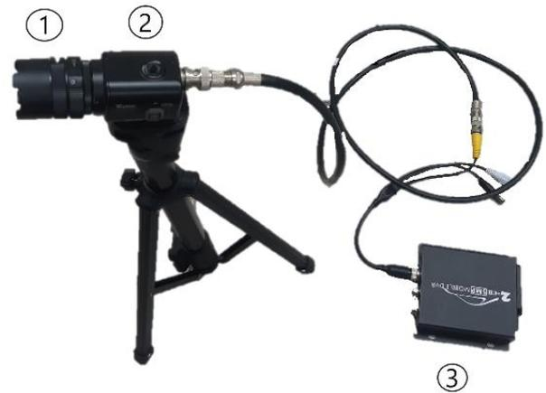
圖 1、影像觀測系統。①可調式單焦鏡頭(H1214FICS) ②Watec 公司製造之高光敏相機(910-HX)③影像資料儲存裝置。
