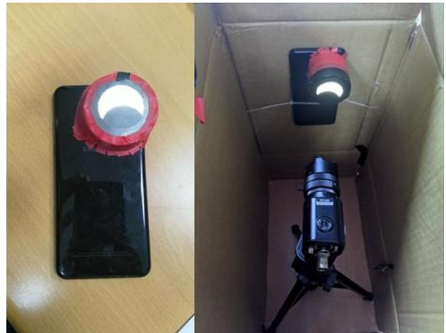
圖 2、日食模擬實驗之示意。左圖為利用手機為模擬光源，介於光源與膠帶之間為減光片(邊界模擬)。右圖為實驗環境，模擬期間將紙箱關閉，黑色膠布貼上以防漏光。
