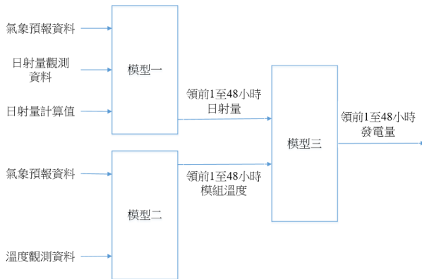
圖一 太陽光電發電量預測機制
