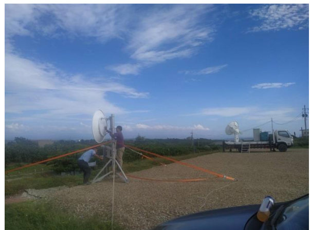
圖十二: 2020/06/04 氣象局四組於雷達站場地架設 Microwave Link 照片。
