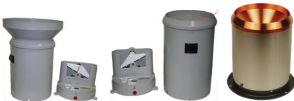
圖 3 國內常見具虹吸調節器傾斗式雨量計
