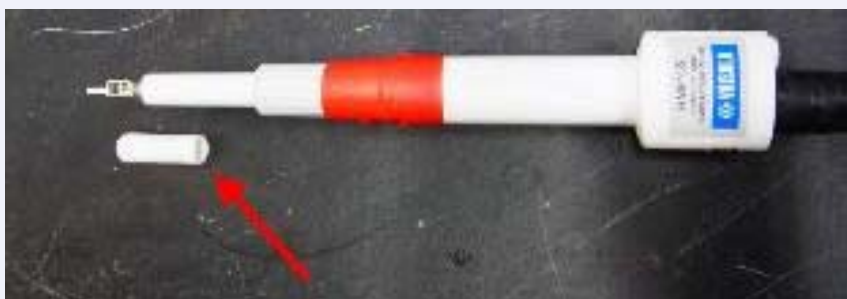
Vaisala HUMICAP®公司所生產的HMP 155型溫濕度計
