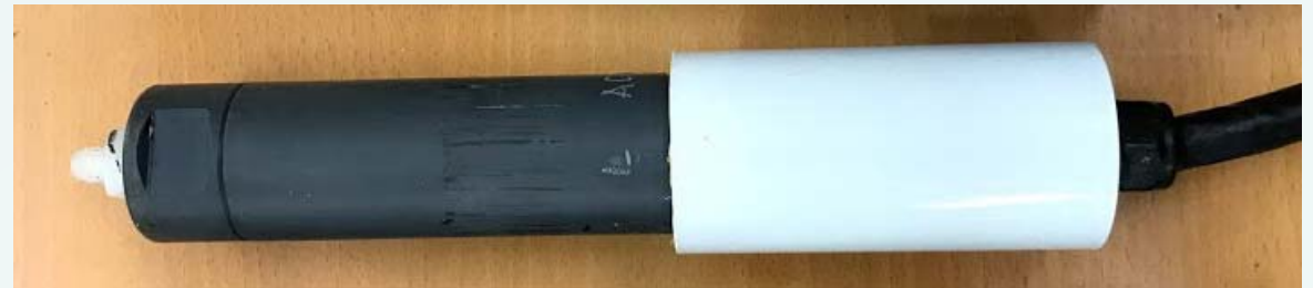
自行設計的電路、聚氯乙稀外殼、可承受50公尺的水壓
