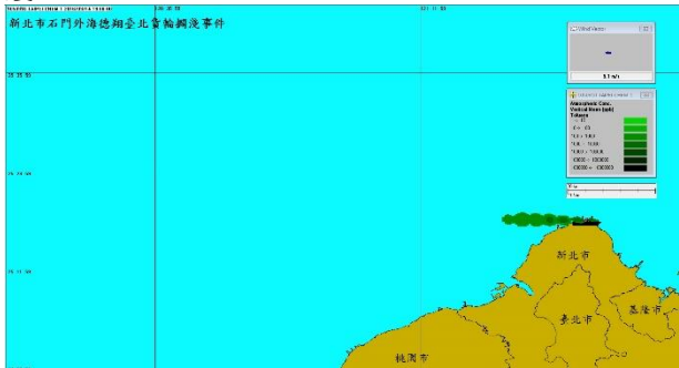
圖 6 甲苯於海水中擴散分布模擬結果 化學品於大氣中隨時間變化狀態圖 甲苯：182 公噸，24 小時
