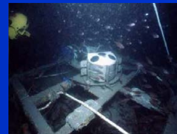
挪威NORTEK公司出品之超音波式波向波高與剖面海流儀器(AWCP)_同時掛載壓力計
