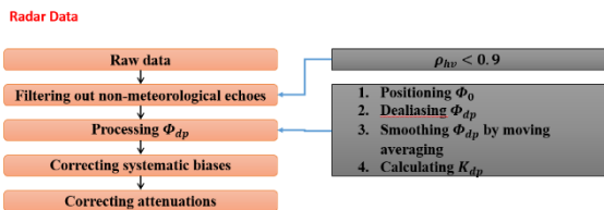
圖4.雷達資料品管處理流程
