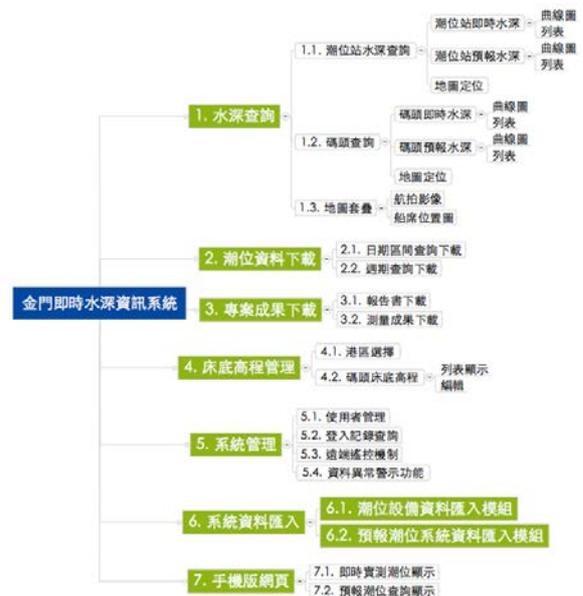
圖14 船席即時水深資訊系統架構圖
