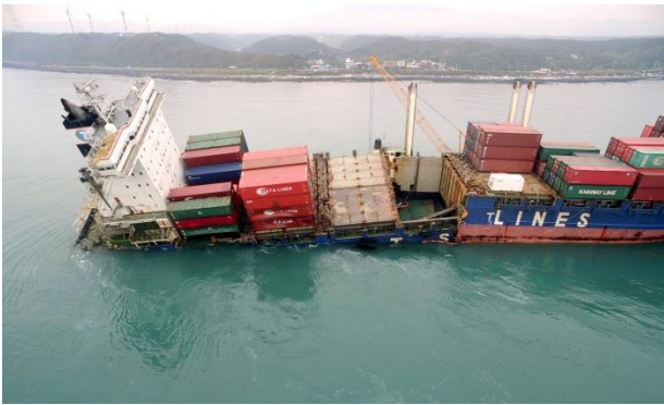
圖2 貨輪擱淺斷裂及油污滲漏情形
