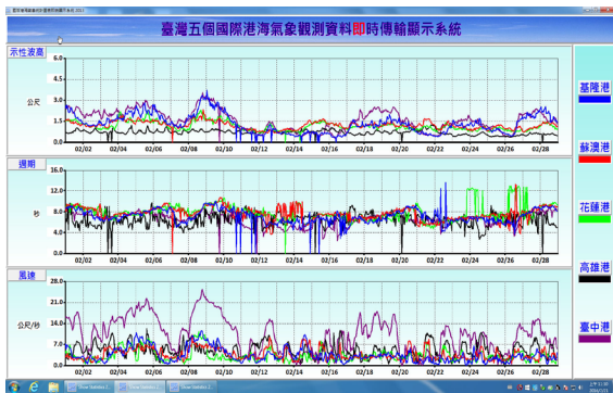
圖4 臺灣環島五大商港2015年2月監測波浪之示性波高(上)與尖峰週期(中)及十分鐘平均風速(下)之逐時變化
