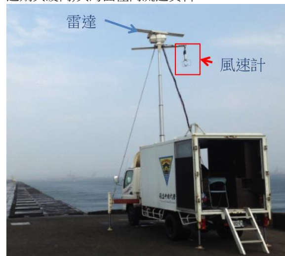
圖1 同調性海象雷達作業情形及風速計佈設位置
