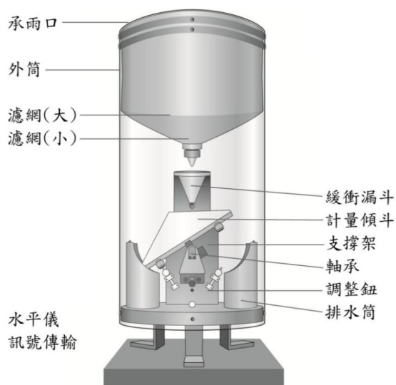
圖 1 傾斗式雨量計各組件介紹
