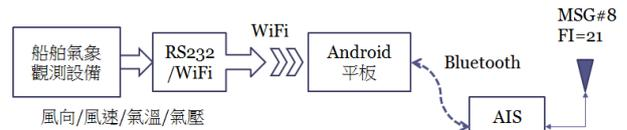
圖六 自動廣播傳送船舶氣象觀測報告的船端系統架構
