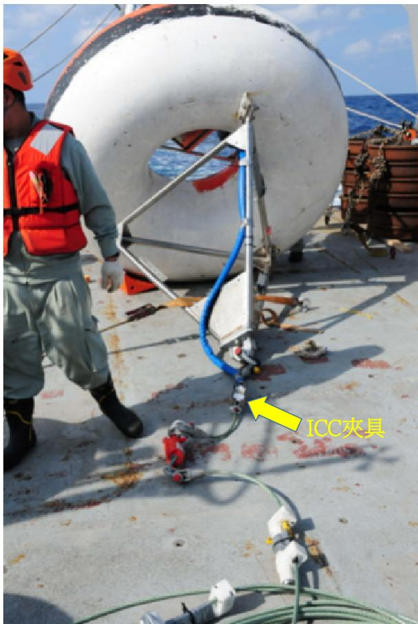
圖 4 感應式夾具 Inductive Cable Coupler(ICC)
