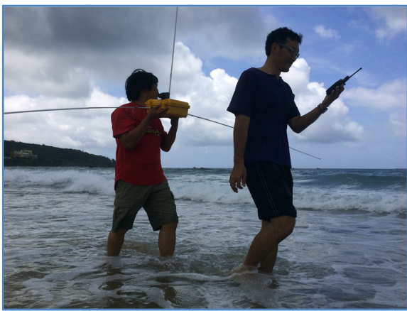
圖1. 步測式天線場型量測 (wAPM) 作業
